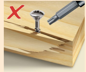
Vissage avec vis à bois aggloméré traditionnelle sans pré-perçage.
